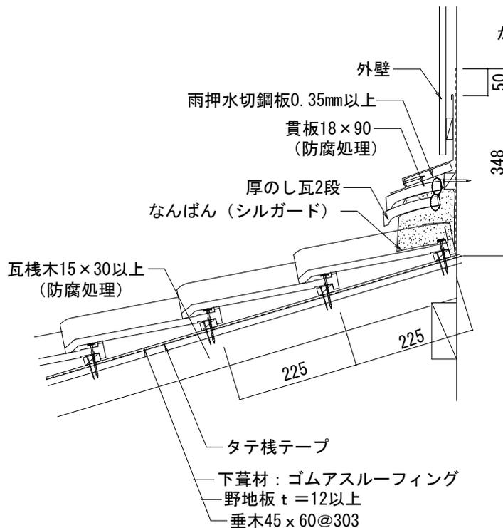
※壁際で切断した棧瓦を用いる場合、緩勾配屋根では特に瓦勾配に注意して施工してください。
