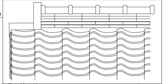
※棟際で切断した棧瓦を用いる場合、緩勾配屋根では特に瓦勾配に注意して施工してください。
