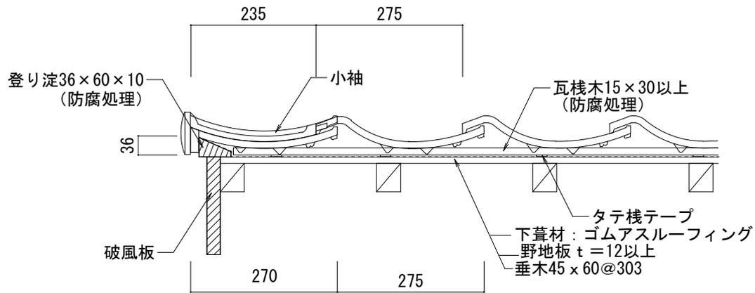
※登り淀（破風板）の高さは、袖瓦と棧瓦の表面が水平になるようにしてください。
