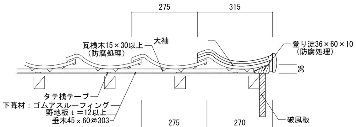
※登り淀（破風板）の高さは、袖瓦と棧瓦の表面が水平になるようにしてください。
