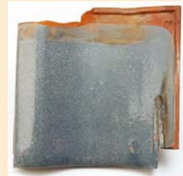
【塩害の影響で崩壊が進んだ瓦】
