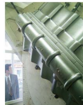
棟回転加力試験 (「瓦屋根標準設計・施工ガイドライン」)
