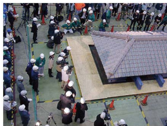
ガイドライン工法で施工されたJ形、F形の屋根の耐震実験。震度7の揺れに対して安全であることが確認されました。 (株式会社間組 技術研究所試験)
