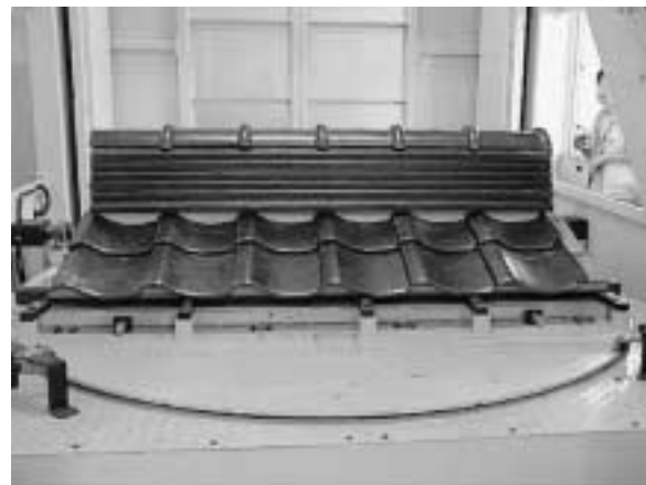
写真 -1-2 棟回転加力試験風景
