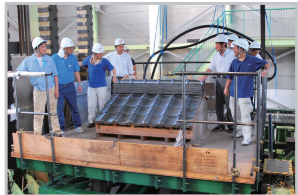
平成24年 瓦屋根の耐震実験(J形瓦)
